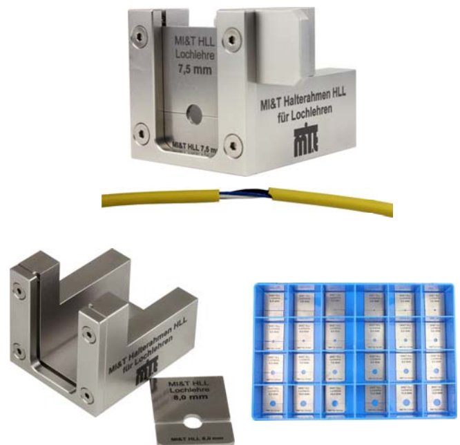
Prüfwerkzeug HLL/MLH 1 zur Kabelmantel-Haftsitzeprüfung
