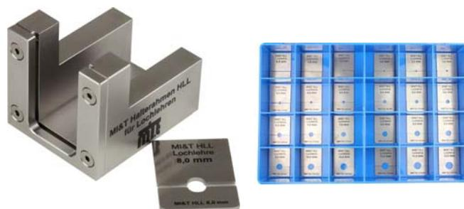
Prüfwerkzeug HLL/MLH 1 zur Kabelmantel-Haftsitzeprüfung
