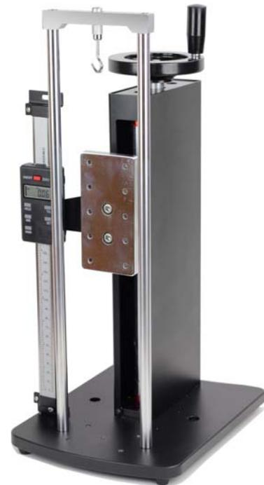
Test Stand TSHL mit Längenmesseinrichtung
