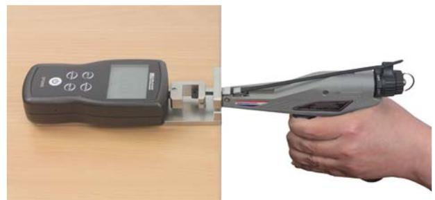
Prüfaufbau mit DFG-KBP 500H
