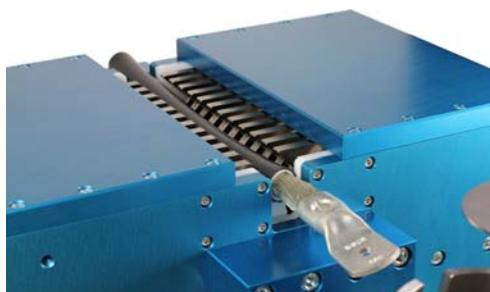
Detail: Kabel-Spanneinrichtung mit Kabel
