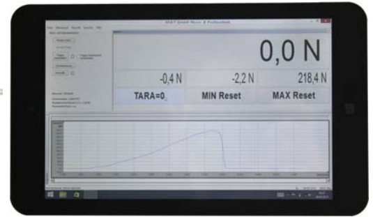
Messwertanzeige mit zusätzlicher Kraft/Zeit-Grafik
