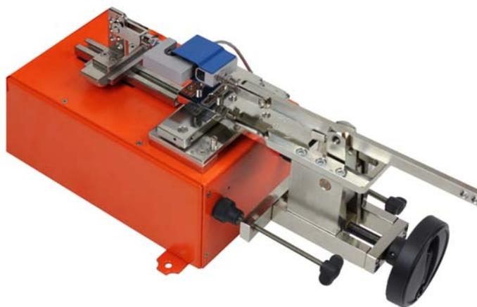
Referenz-Kraftaufnehmer mit Belastungsgerät KB 1000 und 500 N-Referenzkraftaufnehmer
