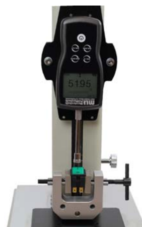
TSM 500 mit Hand Tester DFG, SSK und Druckstößel
